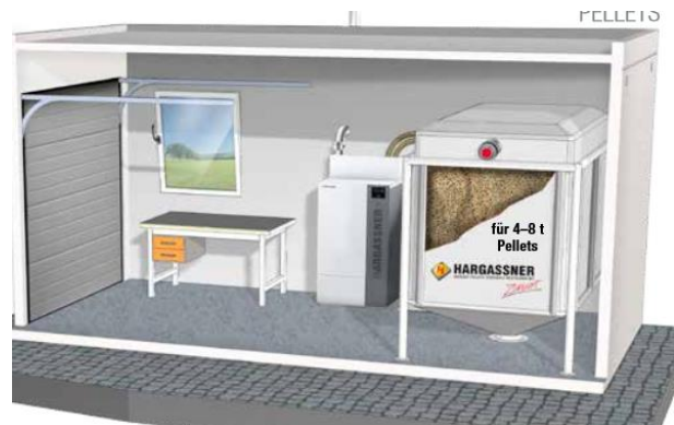
Bild 13: Innenansicht des Heizcontainers mit Pelletkessel
